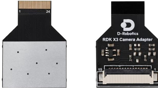
转接板专为 D-Robotics RDK X3 平台设计，可将其原生 CSI 接口转换为 15-PIN、2 通道的标准 CSI 接口，便于连接常见的树莓派兼容摄像头模块，如 OV5647、IMX219 和 IMX477 等。
